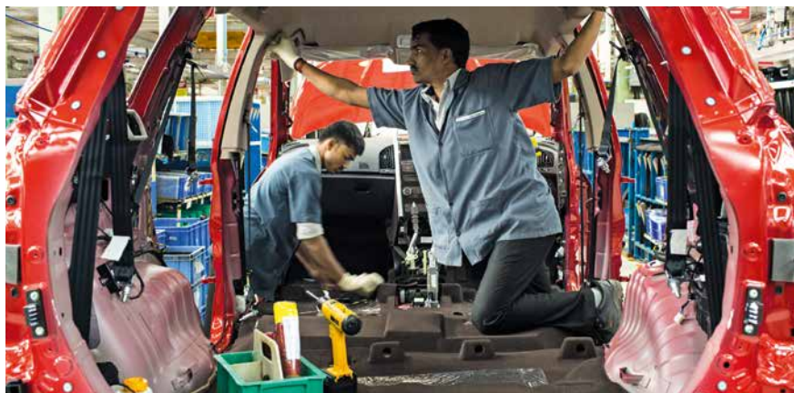
Mahindra & Mahindra-anställda monterar interiörpaneler i en XUV 500 i företagets fabrik i Chakan, Maharashtra i Indien, i september 2014.
